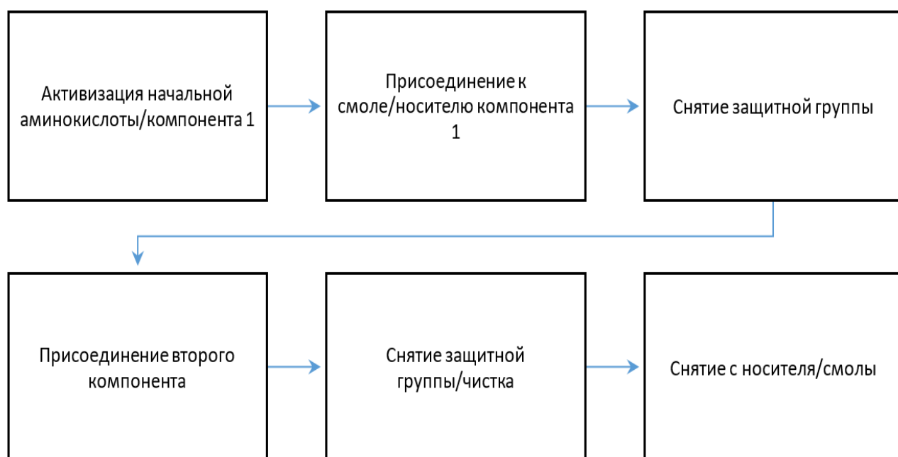
Рисунок 4 - Краткая схема твердофазного синтеза пептидов
